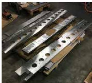
ステンレス、重切削及び長尺物加工
