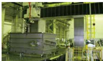
大型五面加工機による真空チャンバー製作
